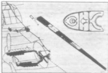
**Warmluft-Enteisung.** Durch Düsen tritt Frischluft in ein Rohrsystem ein und wird durch den Auspuff erwärmt. Die Warmluft wird in den der Flügelvorderkante entlang führenden Flächenabschnitt geleitet und, wie aus dem Querschnitt (oben) ersichtlich, gezwungen, die Außenhaut zu bestreichen, von wo sie in die hinteren Teile der Fläche abfließt. Das in den Führerstrich führende Gestänge dient zur Betätigung der Regelorgane, wie Umschaltbühne usw. Das Bild ist ein Schema der Anlage der Ju 88.
