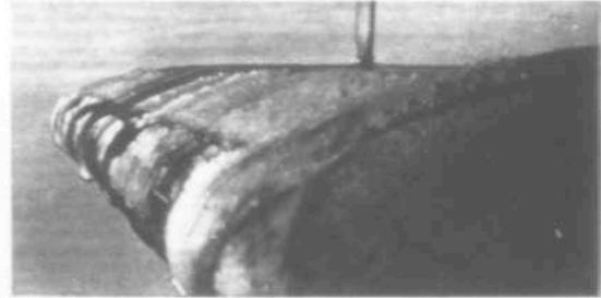
Vereiste Fläche im Fluge. Die Flügelvorderkante ist mit einem Gummientseer versehen, der das Eis teilweise abgesprengt hat
